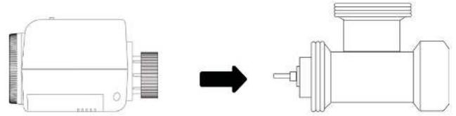
6. Drücken Sie die Auto/Manu Taste. Zeigt das Display F2, so ist das Gerät nicht ordnungsgemäß montiert. Überprüfen Sie dies. Möglicherweise benötigen Sie ein anderes Gewinde. Das Display zeigt bei ordnungsgemäßer Installation **"Ada"** und das ☾ Symbol blinkt. Das Gewinde schließt sich vollständig.
