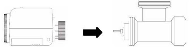
6. Drücken Sie die Auto/Manu Taste. Zeigt das Display F2, so ist das Gerät nicht ordnungsgemäß montiert. Überprüfen Sie dies. Möglicherweise benötigen Sie ein anderes Gewinde. Das Display zeigt bei ordnungsgemäßer Installation **"Ada"** und das ☾ Symbol blinkt. Das Gewinde schließt sich vollständig.
